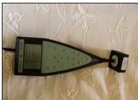
Photo 17 : calibrage des sonomètres avec source de bruit étalon
