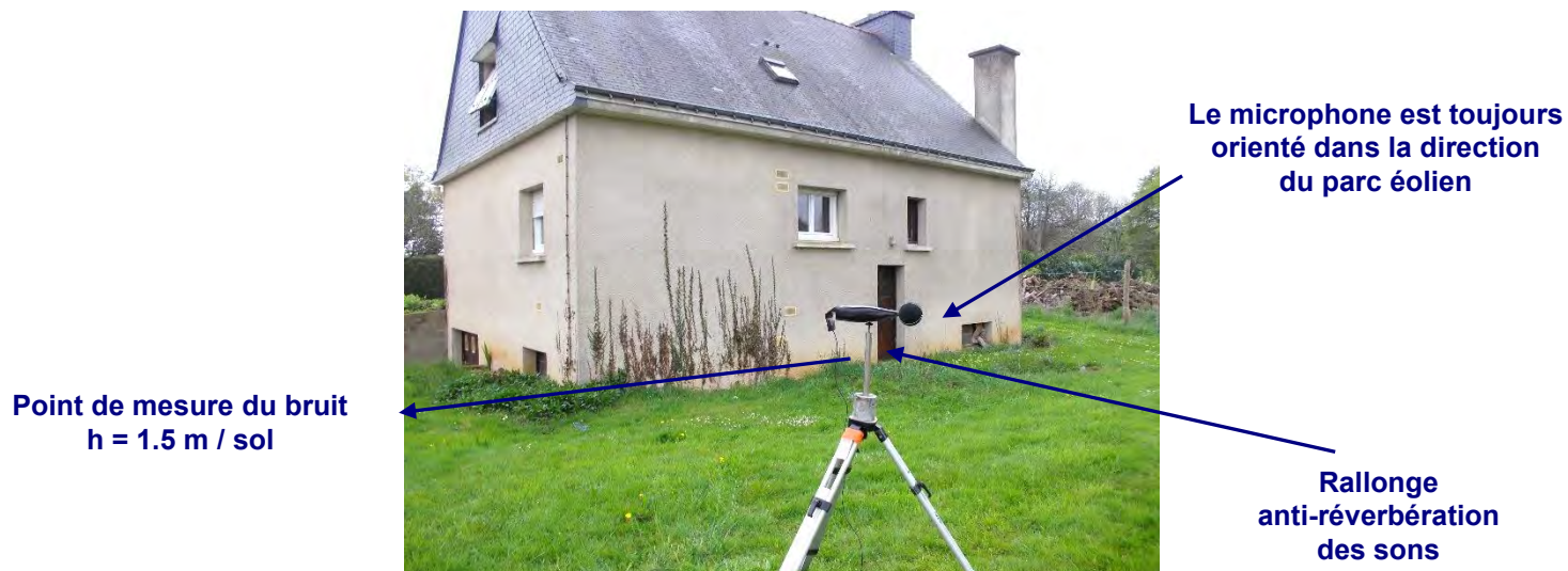
Photo 20 : exemple de mesurage du bruit au point de contrôle
